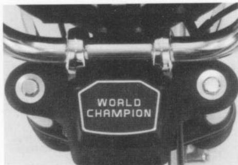
Sechskantmutter SW 32 (Pfeil 3) und Schrauben SW 13 (Pfeile 1 + 2) abschrauben. Obere Gabelbrücke zusammen mit Lenker und – falls vorhanden – mit Cockpit abheben.
