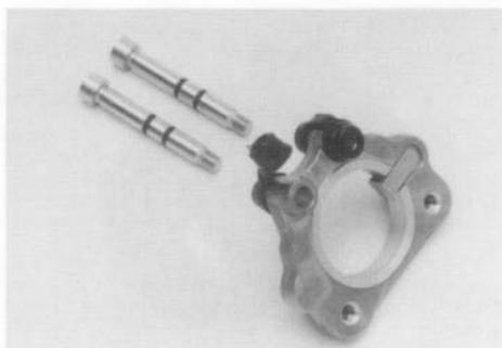
Führungsbolzen mit Drehbewegungen in Sattel und Bremsträger einführen. Scheiben auflegen, Muttern SW 12 ansetzen und festziehen.
