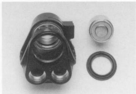
Staubmanschetten vom Kolben abnehmen und Dichtmanschette aus dem Gehäuseschacht herausnehmen, Kolben und Sattel mit Spiritus reinigen. Kolben und Gehäuseschacht mit dem im Reparatursatz „Hydraulik“ befindlichen Spezialfett einfetten und im Gehäuseschacht neue Dichtmanschette einlegen. Kolben vorsichtig in den Gehäuseschacht einführen.
