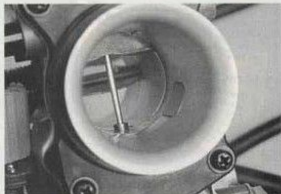
Als de vlakke schuif helemaal omhooggetrokken is, laat die een mooi gevormde venturi vrij, zonder storende uitsparingen.
