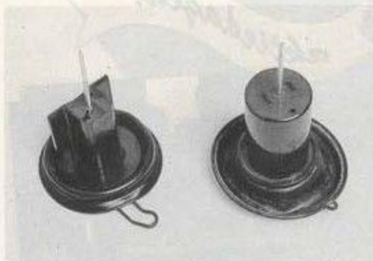
De ronde vacuümzuiger van de CV carburateur (rechts) wordt steeds vaker vervangen door een vlakke schuif (links).
