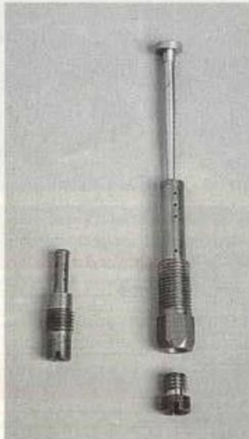
De naaldsproeierhouder, ofwel de mengbuis, is voorzien van een uitgeknipt patroon van gaatjes waardoorheen lucht bij de benzine wordt gemengd. Onderin de mengbuis wordt de hoofdsproeier geschroefd, die de mengverhouding bij volgas bepaalt. Vanaf de bovenkant zakt de naald via de naaldsproeier (niet op de foto) in de mengbuis, en heeft zijn invloed op de luchtbijmenging. Links op de foto staat de stationairsproeier afgebeeld. Ook die is voorzien van gaatjes voor de emulsievorming met de benzine.
