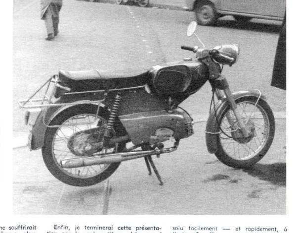
En dehors de la couleur, les différences les plus visibles avec l'ancien Florett sont, bien sûr, le moteur, mais aussi le frein avant plus gros, une fixation différente du phare, un échappement plus volumineux et des amortisseurs arrière à ressort apparent.
