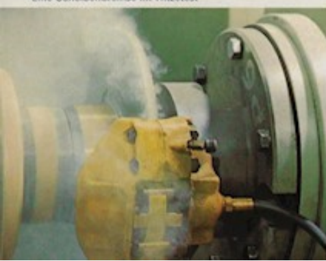
Eine Scheibenbremse im Hitzetest
