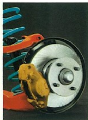
Bremskraftverstärker, Zweikreis-Bremssystem mit Scheibenbremsen vorn.
