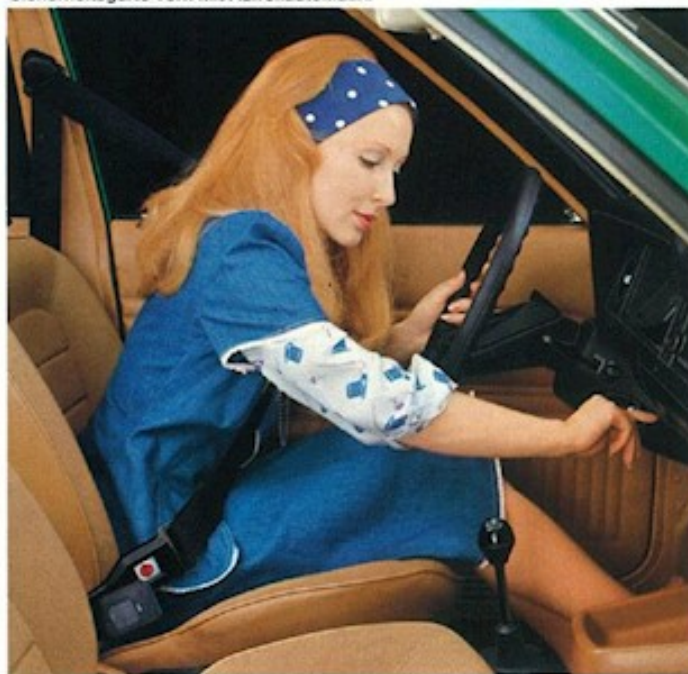
Sicherheitsgurte vorn mit Aufrollautomatik.
