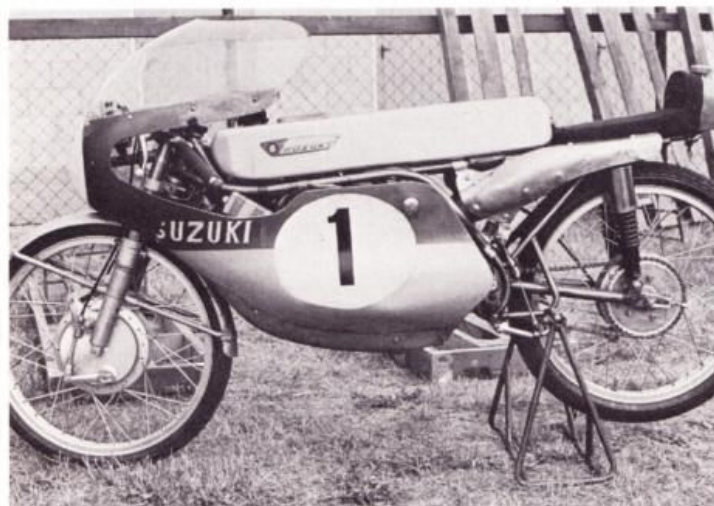
Suzuki's eerste 50 cc twinnetje, de RK-65: 14,5 pk bij 16.500 toeren.
