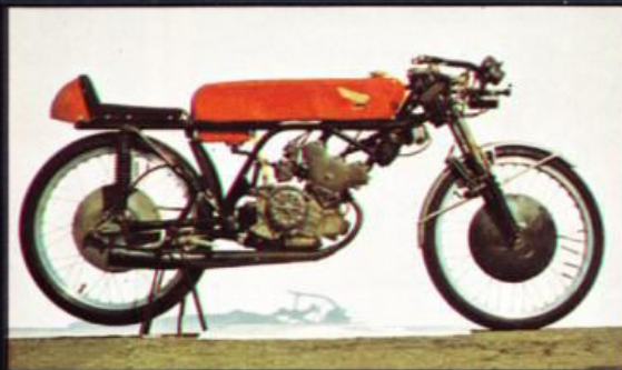
De Honda RC 114 uit 1965, waarmee Ralph Bryans de wereldtitel veroverde. De tweecilinder viertaktmotor leverde 14 pk bij 19.000 t/min.
