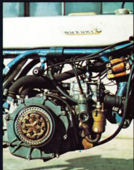
Close-up van de Suzuki RK-67: een watergekoelde 50 cc tweetakt-twin met 14 versnelingen; goed voor 17,5 pk bij 17.300 t/min.
