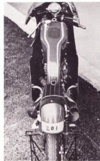
Honda's laatste 50 cc twin, de RC 116 uit 1966. Let op de hooggeplaatste megafontjes.
