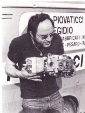
Konstrukteur Jan Thiel met zijn troetelkind, het 50 cc Piovaticci-blok dat naderhand in vrijwel ongewijzigde vorm onder de naam Bultaco drie wereldtitels zou opleveren.
