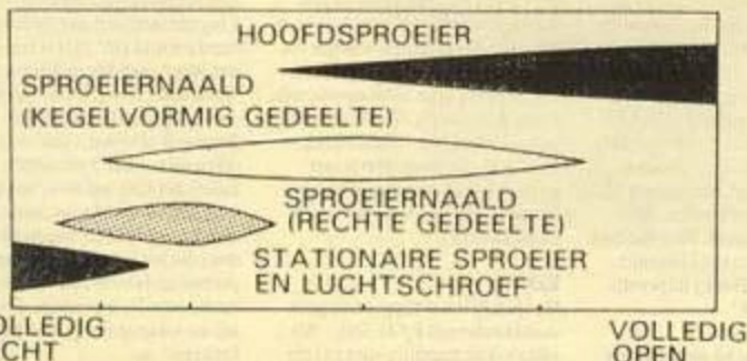
Het schema geeft aan in welke mate de verschillende onderdelen van de carburateur bij een bepaalde stand van het gashendel bepalend zijn voor de mengselsamenstelling.
