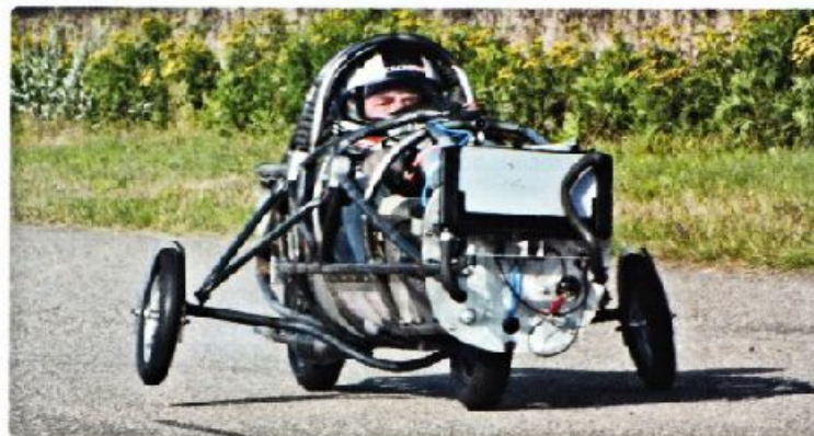
Het bleek bij de testritten moeilijk de steunwielen van de grond te houden.
