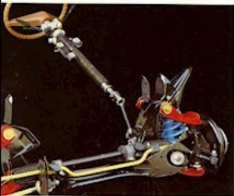
▲ Zweigeteilte, abgewinkelte Sicherheits-Lenksäule
