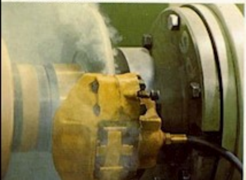
▲ Bremsentest auf dem Ford-Versuchsgelände ▼ Eine Scheibenbremse im Hitzetest
