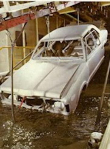
▲ In Lommel (Belgien) besitzt Ford eines der größten Prüfgelände Europas ▼ Grundierung im Elektrolauchbad Salzwasserdurchfahrten überprüfen die Rostbeständigkeit ▼
