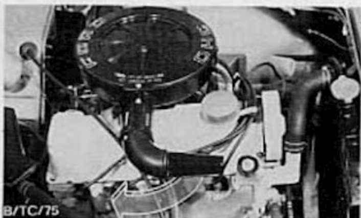
Réglage du filtre à air moteur en ligne
