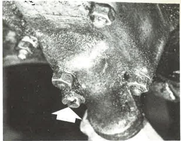
Bild 7 Ölablassschraube an der Getriebeunterseite
