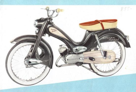
MOTOR: 1-Zylinder-2-Takt-Blockmotor - Hubraum 48 ccm Leistung 2 PS/4650 U/min. - Verdichtung 1:7,5 - Höchstge-schwindigkeit 40 km/h - Luftkühlung durch Fahrtwind Schwungrad-Lichtmagnetzünder 17 W
