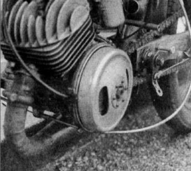
A gauche, vue du moteur, côté volant magnétique. Celui-ci a une fâcheuse tendance à se découper autour de la came qui est rivée. A droite, vue côté embrayage. Notez que le carbu, sans pavillon, approche beaucoup trop du cadre pour que l'arrivée de l'air soit parfaitement libre.
