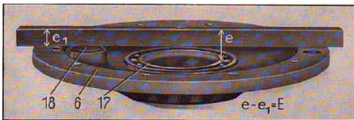
Dans notre exemple,  $E = 9,0$  mm.  $E$  est donc de 0,8 mm plus grand que  $D$ . La différence doit être compensée par des rondelles de réglage
