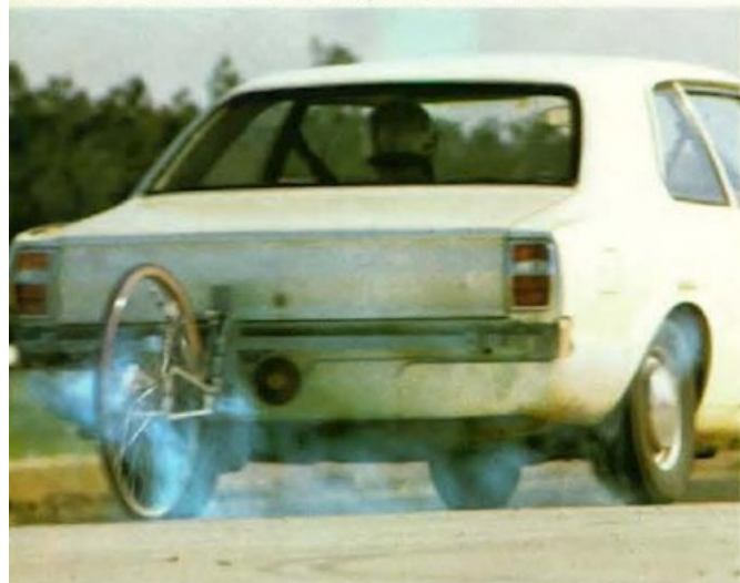
Het testen der remmen op het Ford proefterrein.
