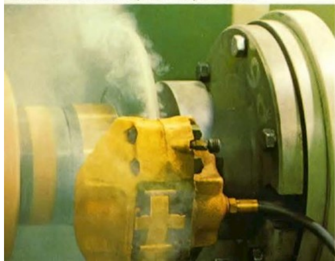
Het testen der remmen op het Ford proefterrein.
