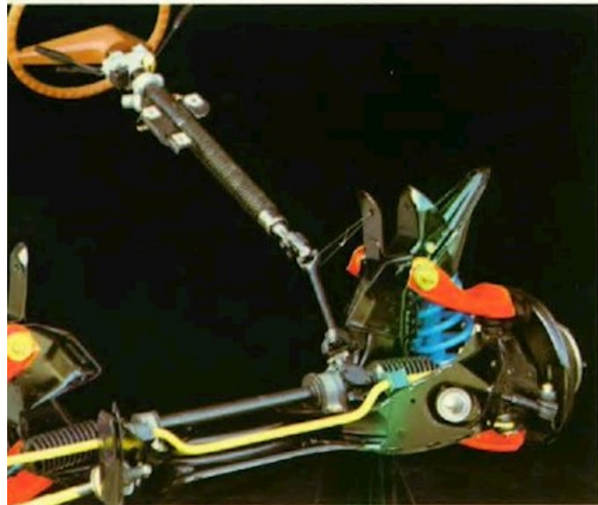
Uit twee delen bestaande veiligheidsstuurkolom.
